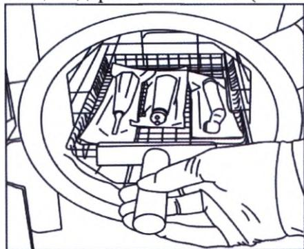
Рис. 7 Загрузка заполненного лотка в стерилизационную камеру.
